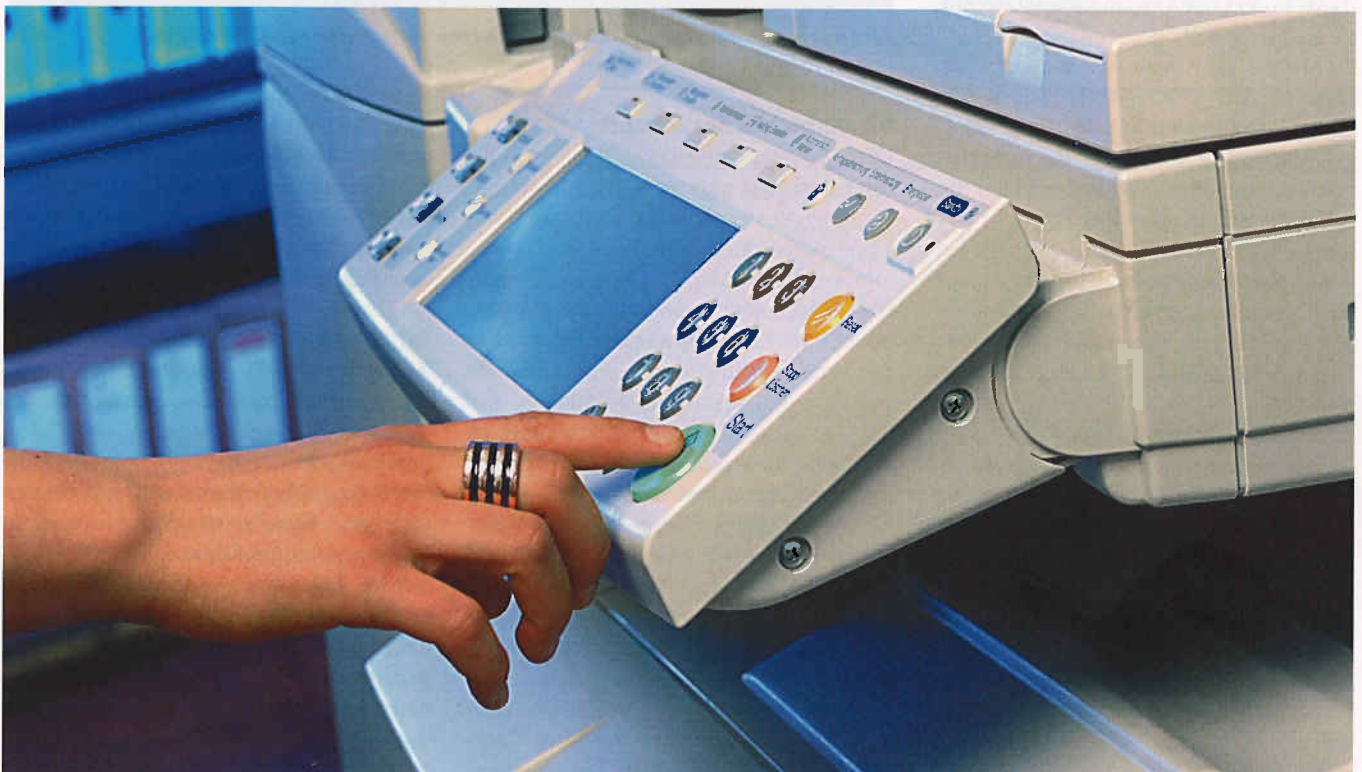
Die Chipkarte wird eingesetzt als Zahlungsmittel für Fotokopien. Der Preis für die Kopien wird vom Kartenguthaben abgezogen. Fotos Imagepoint
